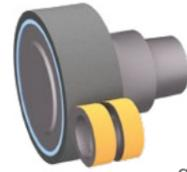
Eine besondere Spezialität des Außenrundschleifens. Es wird beispielsweise bei der Bearbeitung von Nocken für Verbrennungsmotoren eingesetzt. Durch die Maschinenkinematik und ein geeignetes Werkzeug können dabei auch unrunde Geometrien gezielt erzeugt werden.
