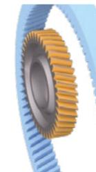
Im Vergleich zu anderen industrierelevanten Verzahnungsschleifprozessen erhalten Sie mit dem Verzahnungshonen in der Regel die höchste Oberflächengüte.
