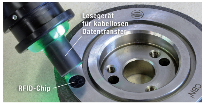
Bild 3. „CBN“-Schleifwerkzeug mit RFID-Chip im Grundkörper sowie Funktionsweise.
